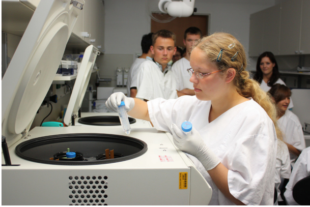
Nele Kross trennt in einer Zentrifuge angezüchtete Bakterienzellen von der Nährlösung
